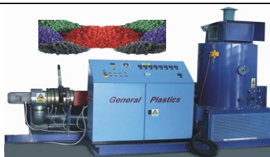
Recykling z odgazowaniem GR-A85D
